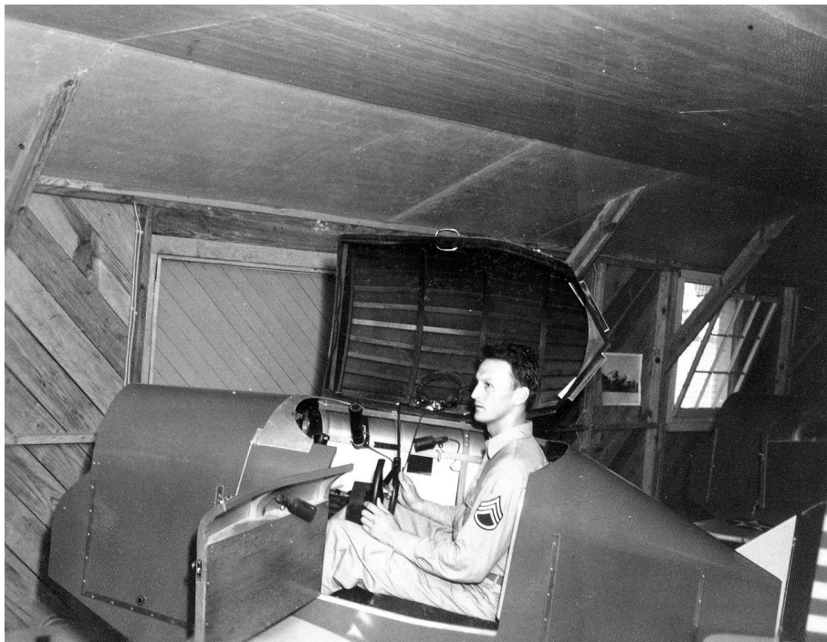
Figura 8: Link Trainer em uso na base militar estadunidense de Freeman Field durante a Segunda Guerra Mundial
