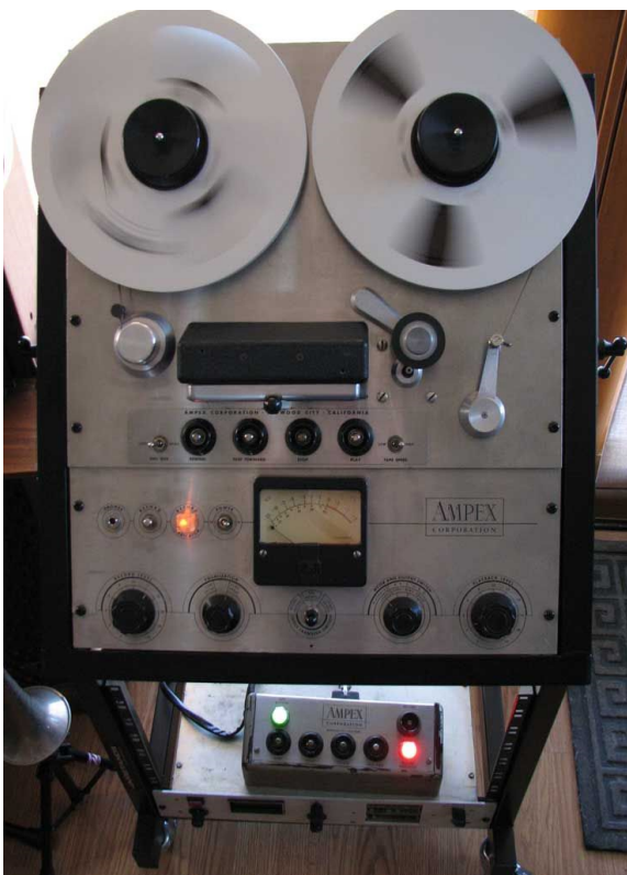
Figura 2: Gravador Ampex 451 com controle remoto na parte inferior do rack . Fonte: acervo pessoal de José Luiz Sasso.
